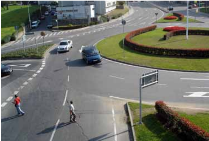
Cruce espontáneo ante la falta de paso peatonal
