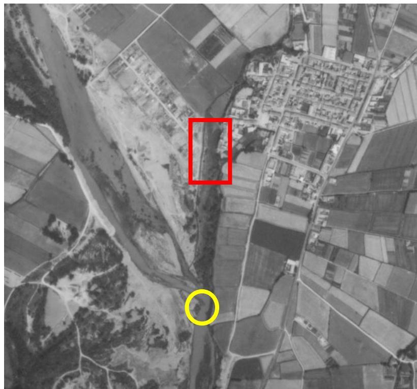
Figura 3. Imagen del vuelo de 1977. El río incide aguas abajo de Peñaflores. La zona “ganada” al río está ocupada por una urbanización. Al pie del pueblo queda una franja en dirección meridiana que queda sin transformar.
