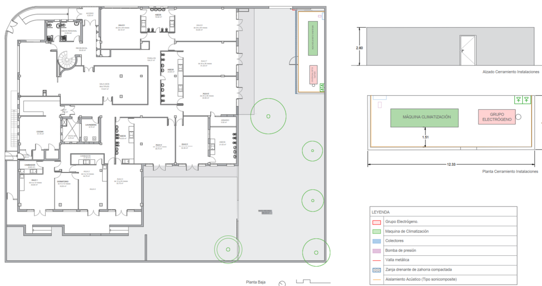
Figura 3. Disposición de la unidad de climatización.
