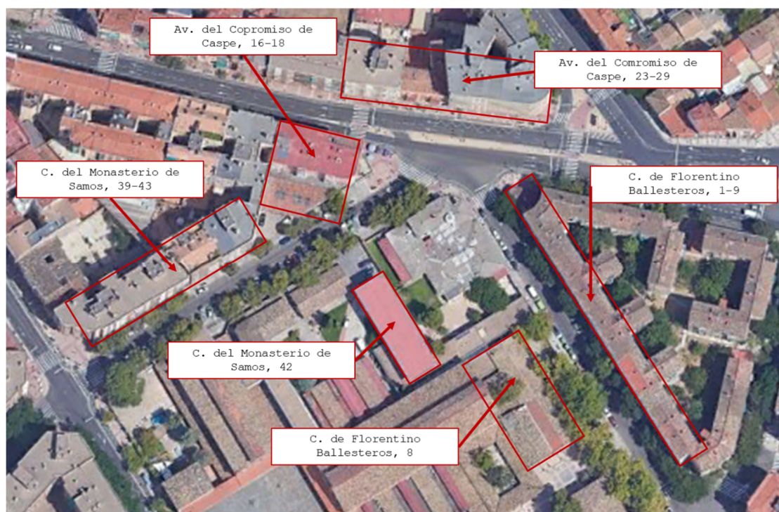
Figura 7. Edificios con fachadas más próximas con partes huecas expuestas al ruido de los emisores acústicos.
