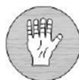
RIESGO DE CORROSION
