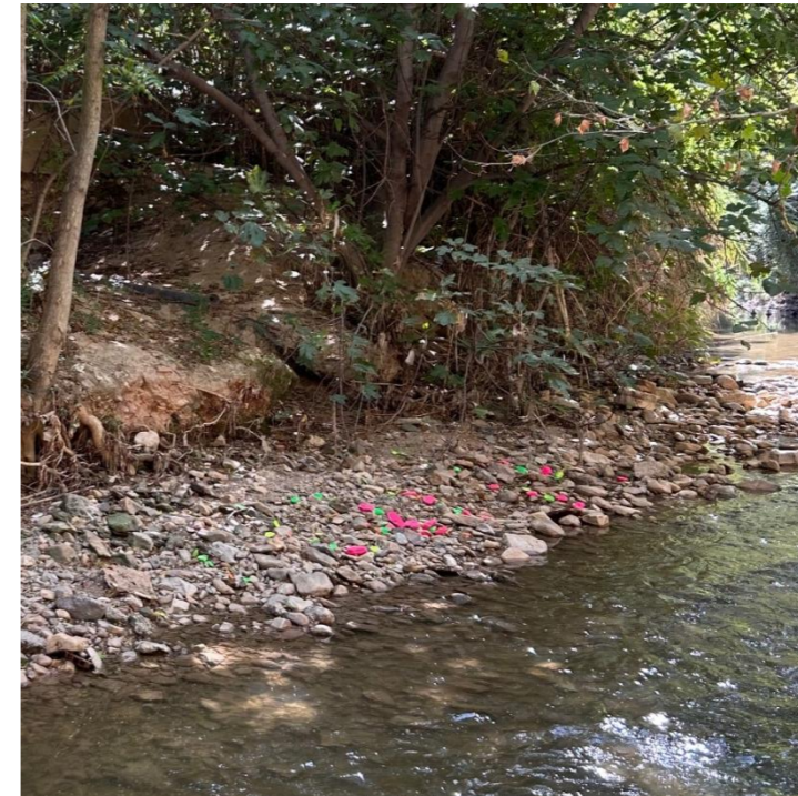
Figura 5. Proceso de identificación, pintura y distribución de las partículas seleccionadas para el estudio del transporte de sedimentos en la barra BA6.
