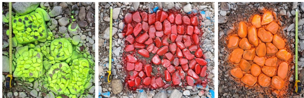
Figura 29. Tamaño y número de sedimentos seleccionado para análisis en la barra BA18. Amarillo: 100 de 20 mm. Rojo: 71 de 44 mm. Naranja: 25 de 60 mm
