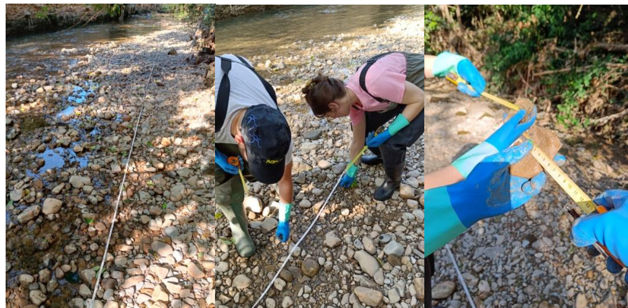
Figura 21. Trabajo de campo (Izquierda: cinta métrica que representa el transepto; centro: selección de las partículas; derecha: medición del eje de las partículas).
