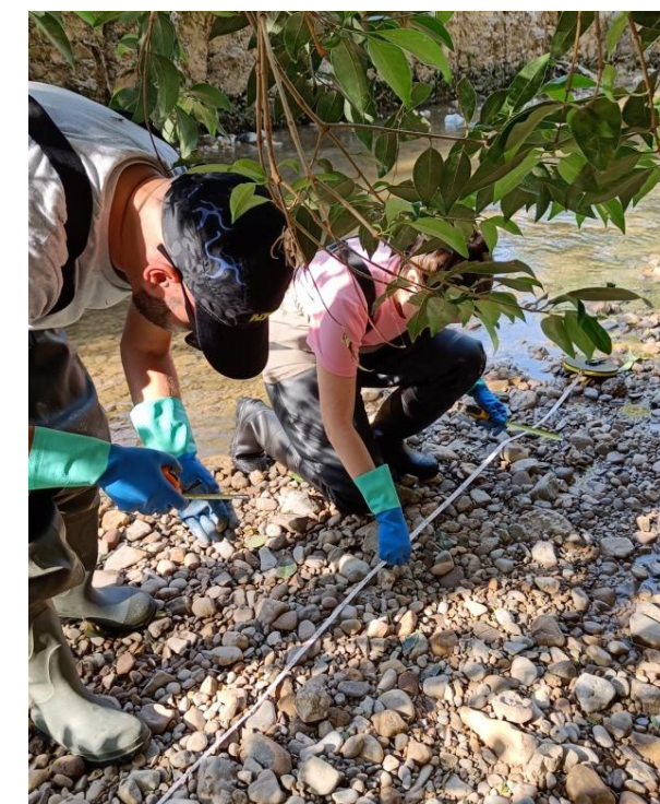
Figura 37. Trabajo de campo (Arriba: recogida de coordenadas GPS de la lámina en la orilla izquierda; abajo izquierda: recogida de coordenadas GPS del cauce; abajo derecha: medición del tamaño de sedimentos para el estudio de granulometría).
