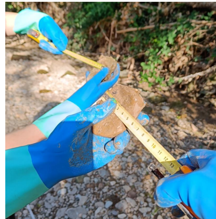
Figura 3. Análisis de granulométrico (Wolman, 1954). Desde la representación del transecto, selección y medición de las partículas.
