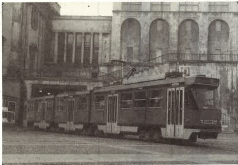
Plaza del Duomo. Milán (Italia). Tranvía «Jumbo», de 8 ejes, atravesando un área peatonal. (Foto Javier Peña).
