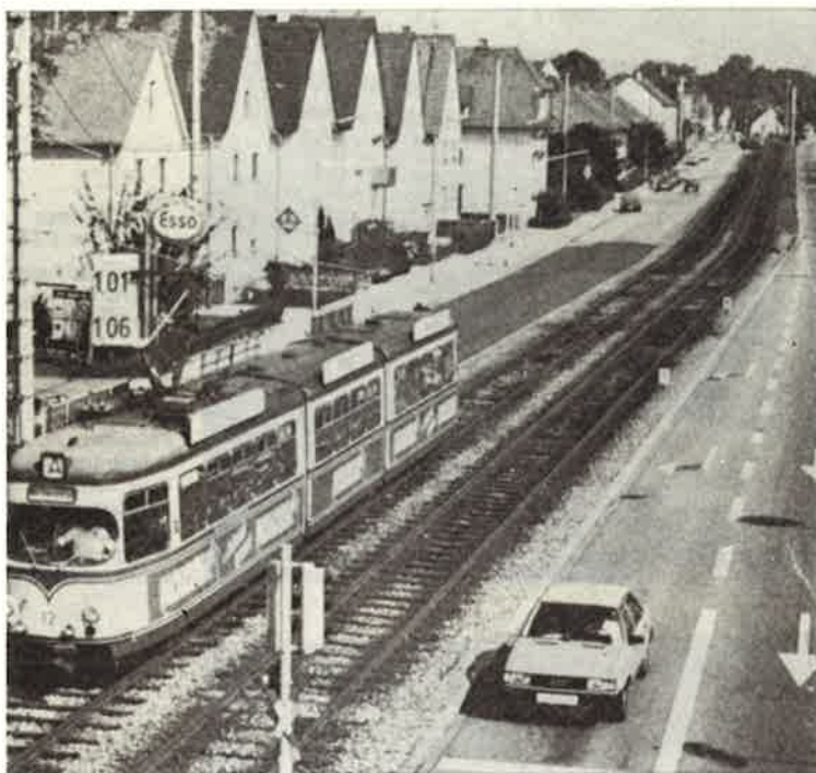
La línea suburbana de tranvías de la ciudad de Karlsruhe (Baden-Württemberg, Alemania) discurre entre la autopista y la calle de servicio —Herrenalbstrasse, Ruppur—. El tranvía es un Düwag, de 8 ejes. (Foto Modern Tramway).
