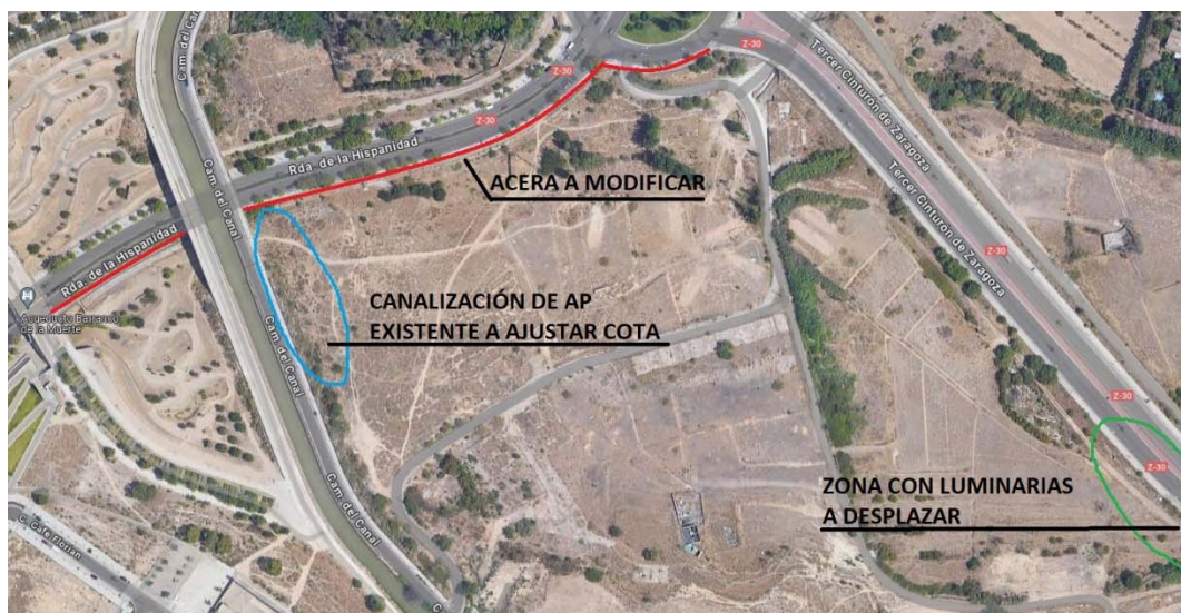
Imagen 1. Zonas perimetrales con afección a la instalación de alumbrado público.
