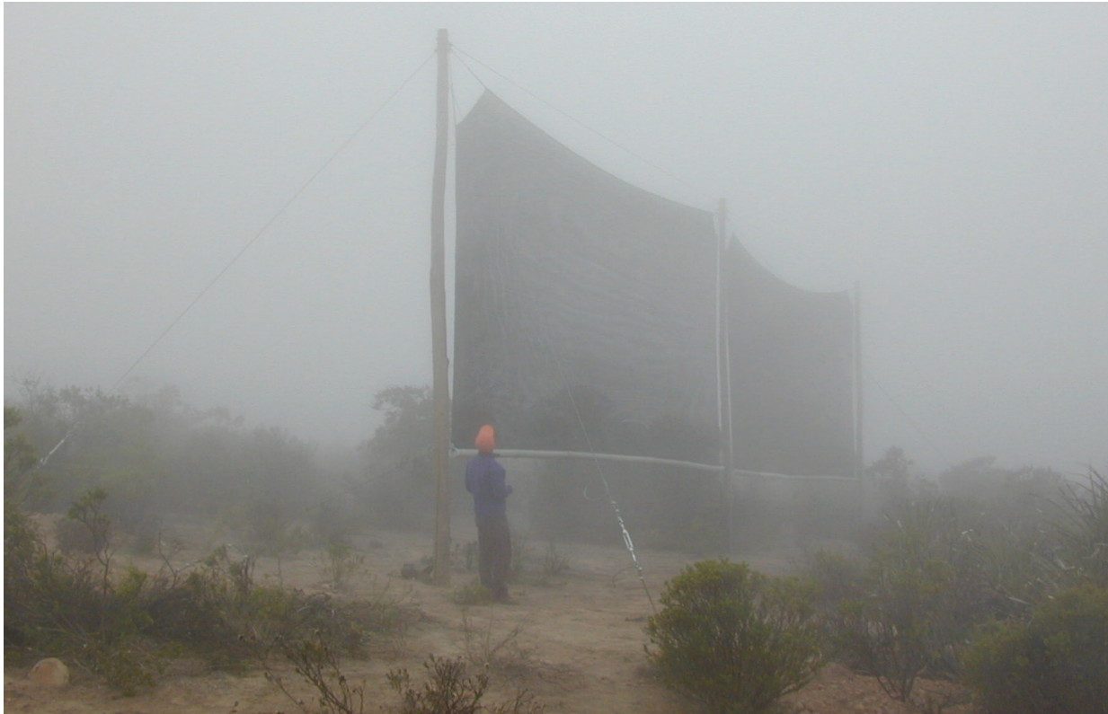
Figure 3. Les collecteurs de brouillard à grande échelle donnent de l'eau lorsque la visibilité est inférieure à 300 mètres (Chili). Photo : R. Schemenauer.
